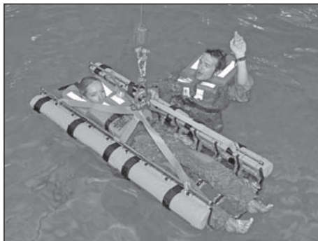
Die Variante des Cosalt-Rettungssystems für den Krankentransport: Die verletzte Person liegt geschützt in der schwimmenden Matte, bevor sie mit einer Winde angehoben wird.
