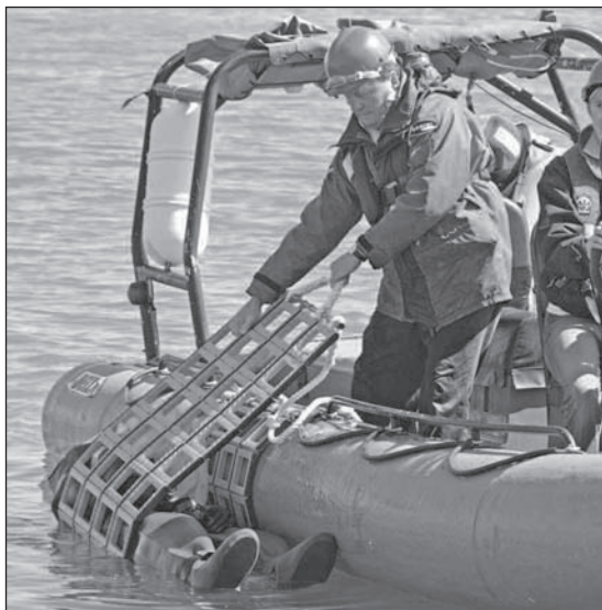
Mit dem Cosalt-Rettungssystem können Personen aus dem Wasser einfach und sanft über die Bordkante ins Boot gerollt werden.
