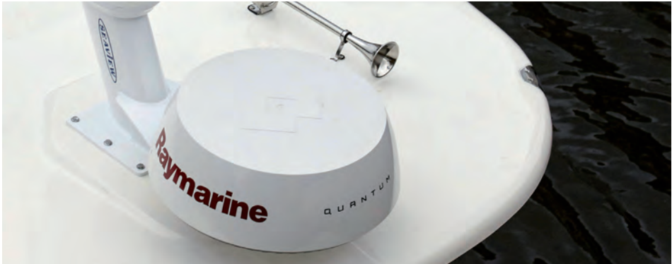
Abb. 5: Das leichte, wie ein Kegelstumpf aussehende Radom des Raymarine Quantum hat einen Durchmesser von 54 cm, sein horizontaler Öffnungswinkel beträgt 4,9 Grad, Entfernungsbereiche von 1/16 bis zu 24 Seemeilen sind nutzbar. Die Qualität der Darstellung ist für ein Gerät mit so kleinem Radom gut.
